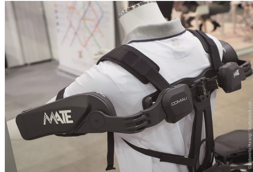
Beispiel eines Exoskeletts, das die Armbewegung bei wiederkehrenden manuellen Arbeiten unterstützen soll.
